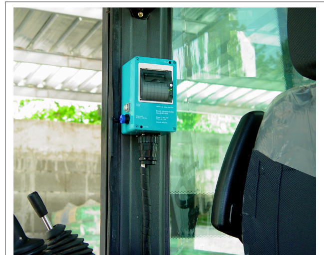
Илюстрация 2: Контролер с термопринтер, 57 мм лента
