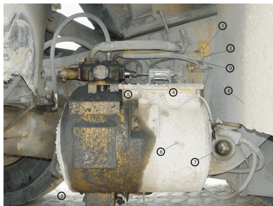
Илюстрация 3: Хидравлична система на самосвал Wabco 510, с монтиран датчик за налягане
