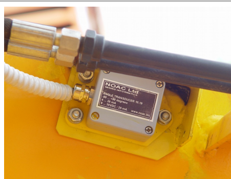
Илюстрация 3: Инклинометър за наклона на стрелата
