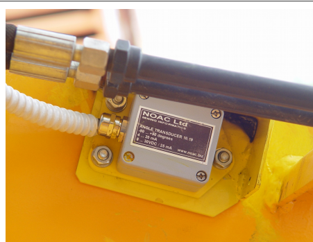
Илюстрация 3: Инклинометър за наклона на стрелата
