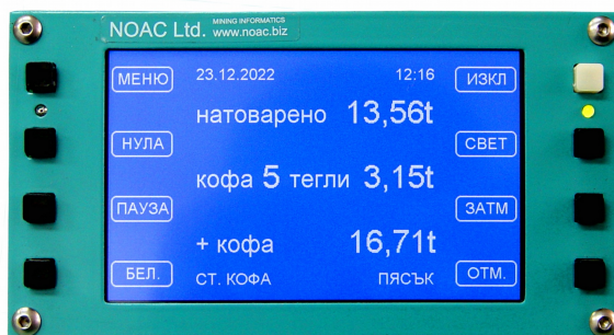
Илюстрация 1: Дисплей на водача – 8x20 символа
