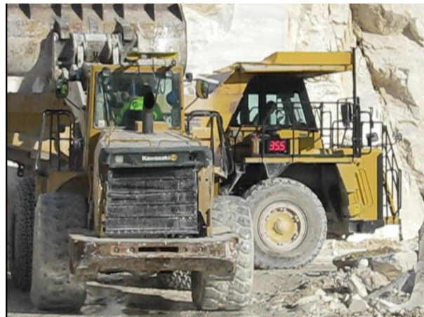
Илюстрация 1: Показания в режим на товарене. Натоварени 35.5 t, самосвал Komatsu, 40-тонен. Виж видео на https://www.dropbox.com/s/29a6abvuu3p30i7/sgd005.avi?dl=0
