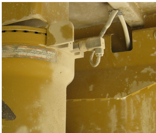
Илюстрация 6: Преден амортисьор Cat 771D с монтиран сензор
