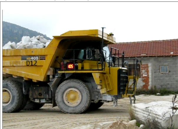
Илюстрация 2: Индикация по време на движение. Средна скорост 10.5 km/h. Виж видео на https://www.dropbox.com/s/0dlzh2454khi53z/video004.avi?dl=0
