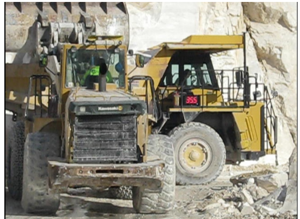
Илюстрация 1: Показания в режим на товарене. 35.5 t, самосвал Komatsu, 40t
