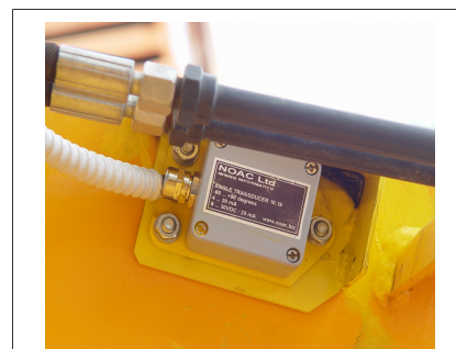
Илюстрация 1: Инклинометър за наклона на стрелата със защитна козирка
