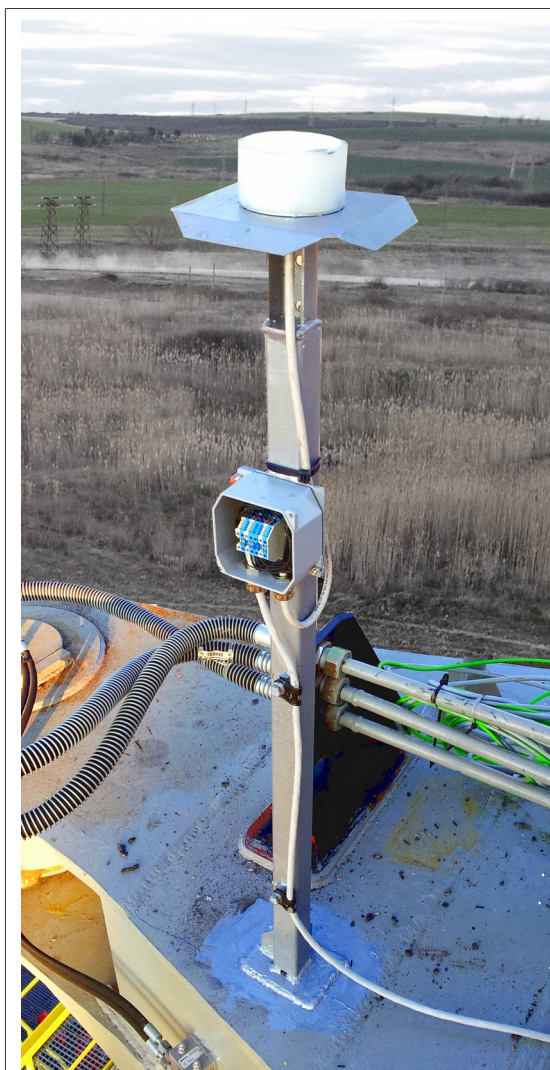
Илюстрация 1: Външен вид на устройството, монтирано на роторен багер. Разводната кутия е отворена.
